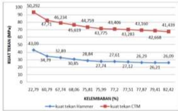
Gambar 7. Hubungan kuat tekan hammer test dengan CTM
