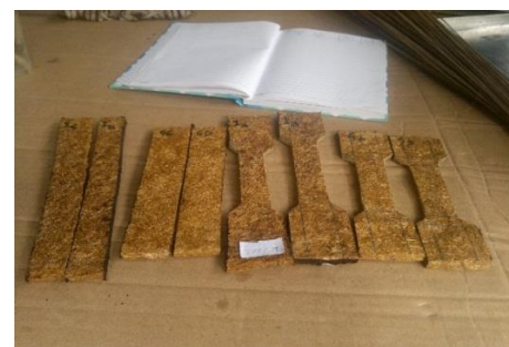
Gambar 5. Spesimen Uji Lentur dan Uji Tarik
