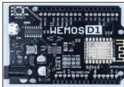
Gambar 2.3 Bentuk Fisik Dari Wemos D1[17].
