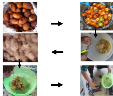
Gambar 1. Proses Pembuatan Sampel Komposit Serat Pinang
