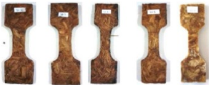
Gambar 2. Sampel uji tarik komposit serat pinang
