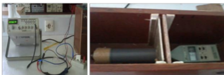
Gambar 1. Skema alat pengukuran Taraf Intensitas Bunyi
