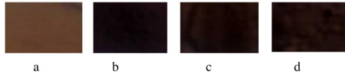
Gambar 2. \text{BaFe}_{11,8}\text{Co}_{0,2}\text{O}_{19} (a) T= 80^\circ\text{C} (b) T= 400^\circ\text{C} (c) T= 600^\circ\text{C} dan (d) T= 800^\circ\text{C}
