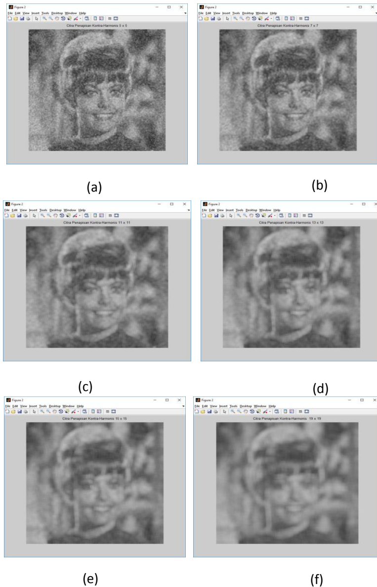
Gambar 4.14 Hasil penapisan Kontra-Harmonis (a) 5x5, (b) 7x7, (c) 11x11, (d) 13x13 (e) 15x15, dan (f) 19x19
