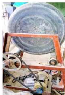
Gambar 1. Mesin pelapisan benih yang digunakan dalam riset ini, terdiri atas kerangka baja dilengkapi motor penggerak (2 PK, 750 watt) dan drum PVC (300 L) yang diputar dengan motor penggerak tersebut pada kecepatan 30–40 rpm.
