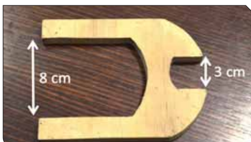
Gambar 35 Alat Pengukur Batang untuk Pemangkasan ( Pruning Gauge ) (Kontributor foto: Dede Rohadi)
