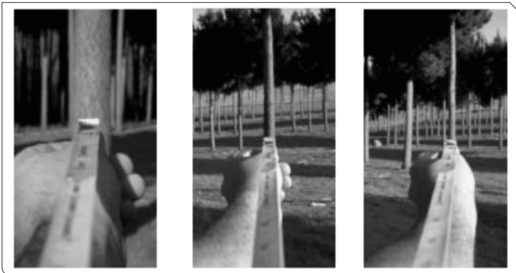
Gambar 21 Cara pengukuran Luas Bidang Dasar Tegakan dengan Metode Optik (Sumber: Tree and Stand Measurement)
