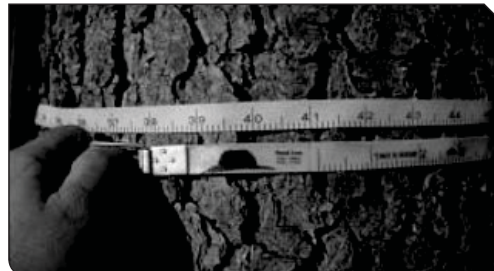
Gambar 13 Pengukuran Diameter Pohon dengan Pita Ukur MTG (Sumber: Tree and Stand Measurement)
