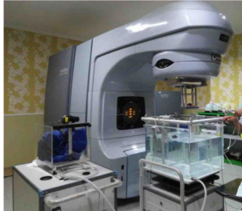
Gambar 1. Pengukuran PDD dan Dose Profile
