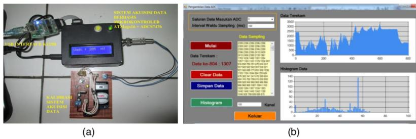
Gambar 4. (a) Perangkat akuisisi data berbasis ATMega16 dan ADCS7476, (b) Tampilan program akuisisi data.
