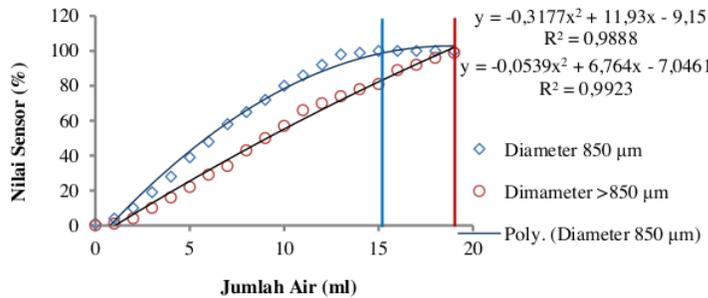
Gambar 9. Grafik hasil pengujian soil moisture sensor FC-28 pada sampel pasir dengan massa 1846 gram.
