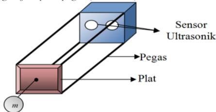
Gambar 4. Skema sistem mekanik pendeteksi pergeseran tanah
