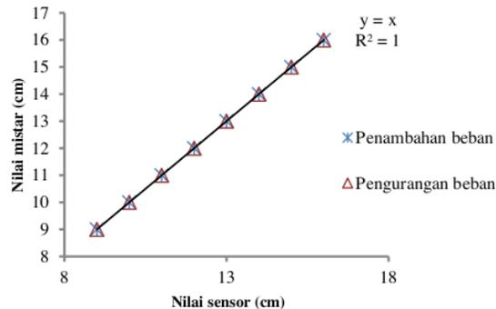
Gambar 7. Grafik hasil pengujian keakurasian sensor ultrasonik SRF08 dengan pembanding mistar
