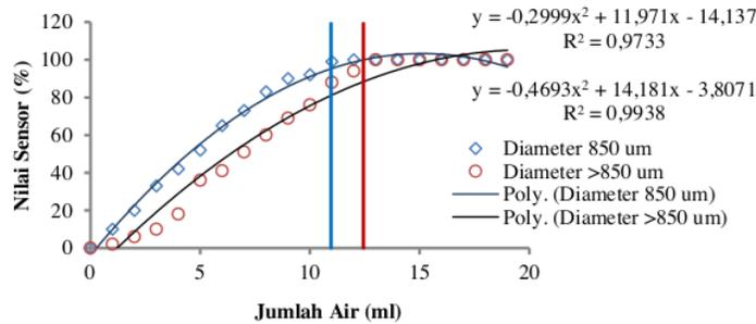
Gambar 8. Grafik hasil pengujian soil moisture sensor FC-28 pada sampel pasir dengan massa 1029,7 gram
