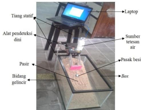
Gambar 5. Pengujian alat pendeteksi longsoran material di laboratorium
