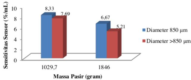
Gambar 10. Grafik tingkat sensitivitas *soil moisture sensor FC-28* pada sampel pasir
