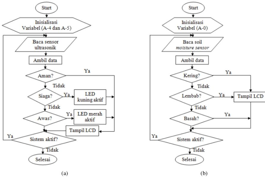
Gambar 3. Diagram alir sistem pendeteksi dini bencana tanah longsor: (a) diagram alir kerja sensor ultrasonik SRF08, (b) diagram alir kerja sensor soil moisture FC-28
