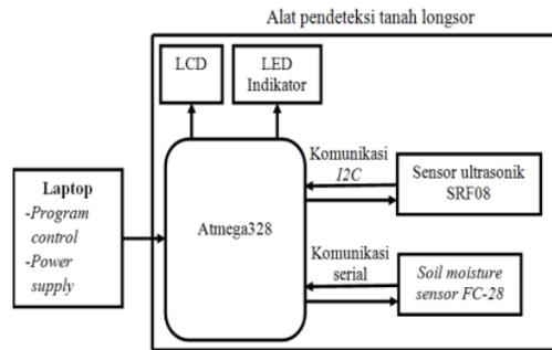
Gambar 1. Skematik rancangan sistem pendeteksi pergeseran tanah.
