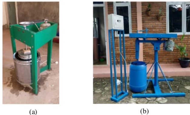
Gambar 2 Perbandingan mesin es krim a) sebelum aplikasi ergonomi, b) setelah aplikasi ergonomi [18]
