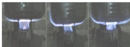
Gambar 4.4 kompor alkohol diameter inner pipe 1 1/2 inchi dengan variasi jumlah jet hole 8 buah, 12 buah, 16 buah
