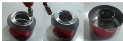
Pembuatan lubang bahan bakar Pembuatan lubang jet hole Gabungkan Inner pipe dan bagian bawah kompor
