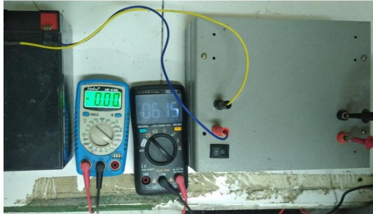
**Gambar L.1.** Proses pengukuran tegangan sumber arus injeksi.
