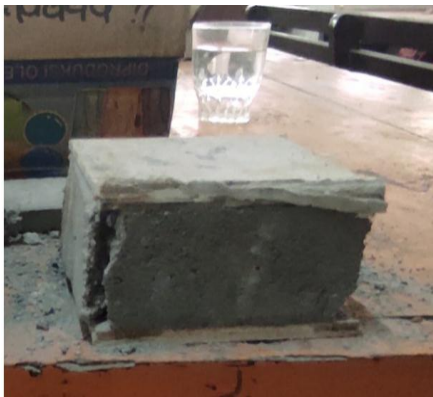
Gambar 4.6 Hasil pengujian tekan arah tepi variasi sudut 60^\circ
