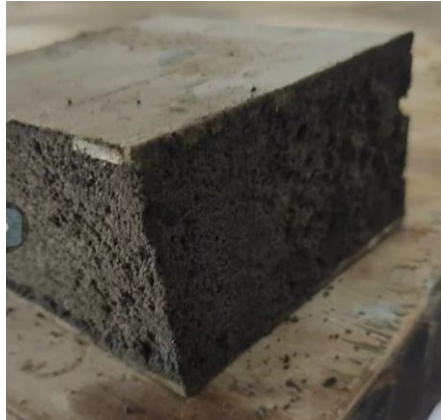
Gambar 3.10 Hasil percobaan awal pembuatan komposit sandwich beton ringan diperkuat pin bambu
