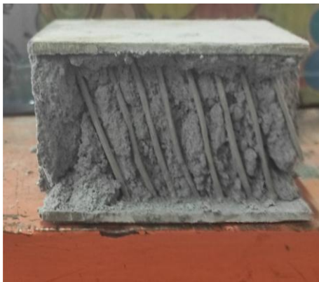
Gambar 4.3 Hasil pengujian tekan arah flat variasi sudut 75^\circ
