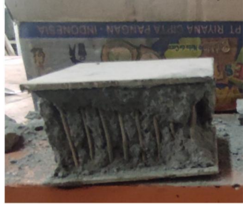
Gambar 4.2 hasil pengujian tekan arah flat variasi sudut 90^\circ
