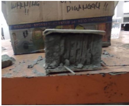
Gambar 4.5 Hasil pengujian tekan arah tepi variasi sudut 90^\circ
