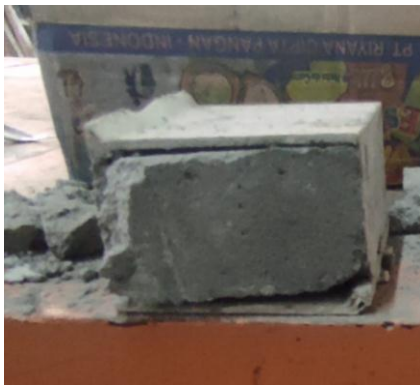
Gambar 4.6 Hasil pengujian tekan arah tepi variasi sudut 75^\circ
