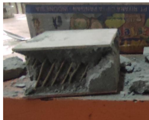
Gambar 4.4 Hasil pengujian tekan arah flat variasi sudut 60^\circ
