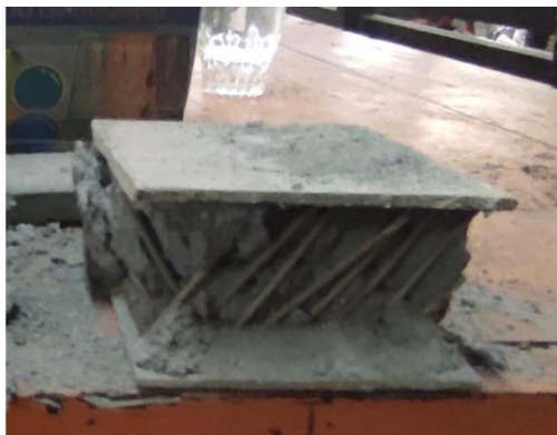
Gambar 4.4 Hasil pengujian tekan arah flat variasi sudut 60^\circ
