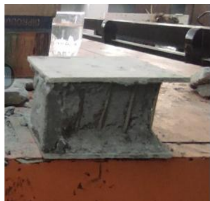
Gambar 4.3 Hasil pengujian tekan arah flat variasi sudut 75^\circ
