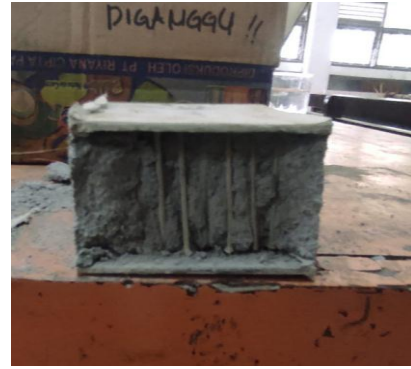
Gambar 4.5 Hasil pengujian tekan arah tepi variasi sudut 90^\circ
