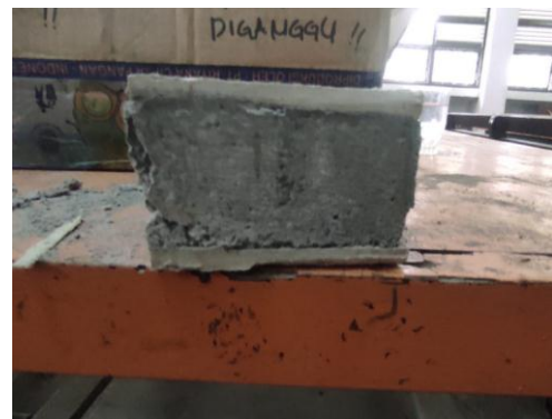
Gambar 4.6 Hasil pengujian tekan arah tepi variasi sudut 60^\circ
