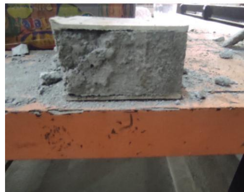
Gambar 4.6 Hasil pengujian tekan arah tepi variasi sudut 75^\circ
