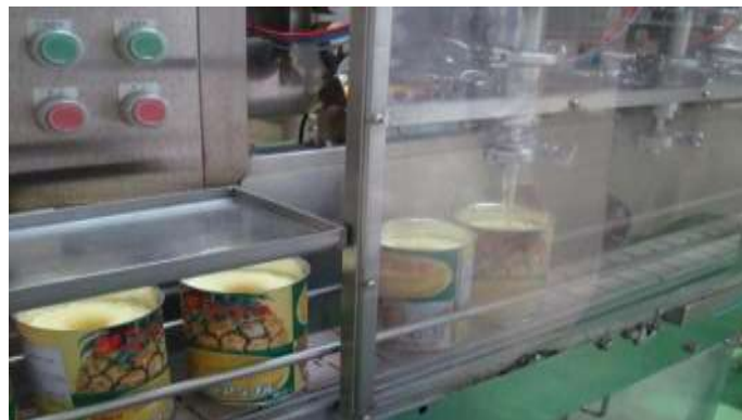
Gambar 3 12 Proses Pengisian Sirup Menggunakan Mesin Otomatis
