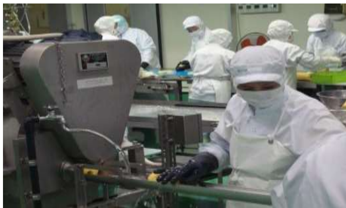
Gambar 3 9 Proses Pencucian Buah Nanas Dan Penyaluran Buah Nanas Ke Mesin Resizing Machine .
