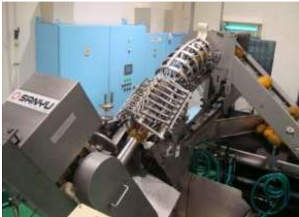
Gambar 3 7 Proses Pengupasan Dan Pembuangan Empelur Buah Nanas.
