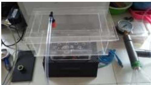
Gambar 5.3 Hasil Perancangan Sistem Telemetri Monitoring Gas Buangan Karbondioksida (CO 2 ) dengan box tabung gas.
