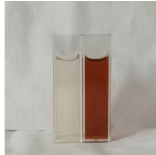
Gambar 1. Perbandingan ekstrak daun lamtoro (kiri) dan nanopartikel perak (kanan)
