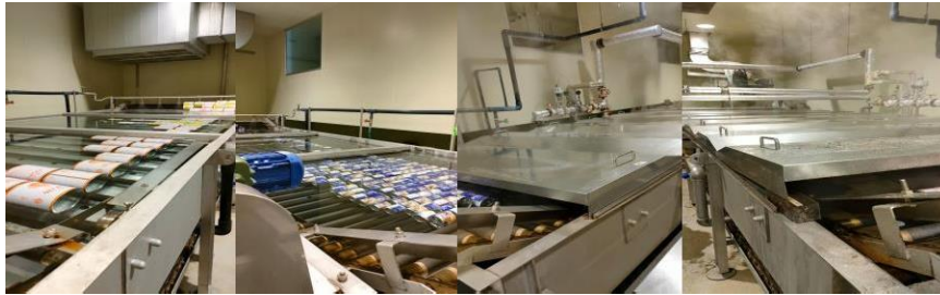
Gambar 8. Proses sterilisasi nanas kaleng
