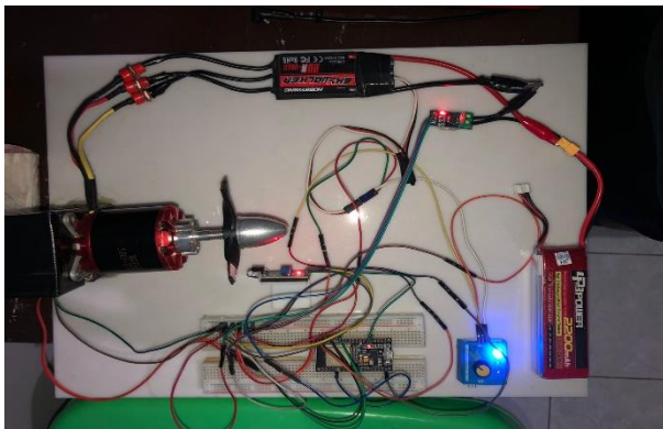
Gambar 11 Perangkat Keras Sistem Monitoring Motor BLDC.
