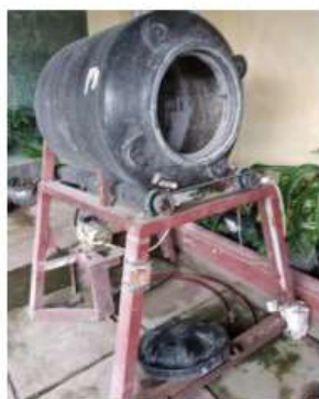
Gambar 1. Mesin pelapisan benih yang digunakan dalam riset ini, terdiri atas kerangka baja dilengkapi motor penggerak (2 PK, 750 watt) dan drum PVC (300 L) yang diputar dengan motor penggerak tersebut pada kecepatan 30–40 rpm.
