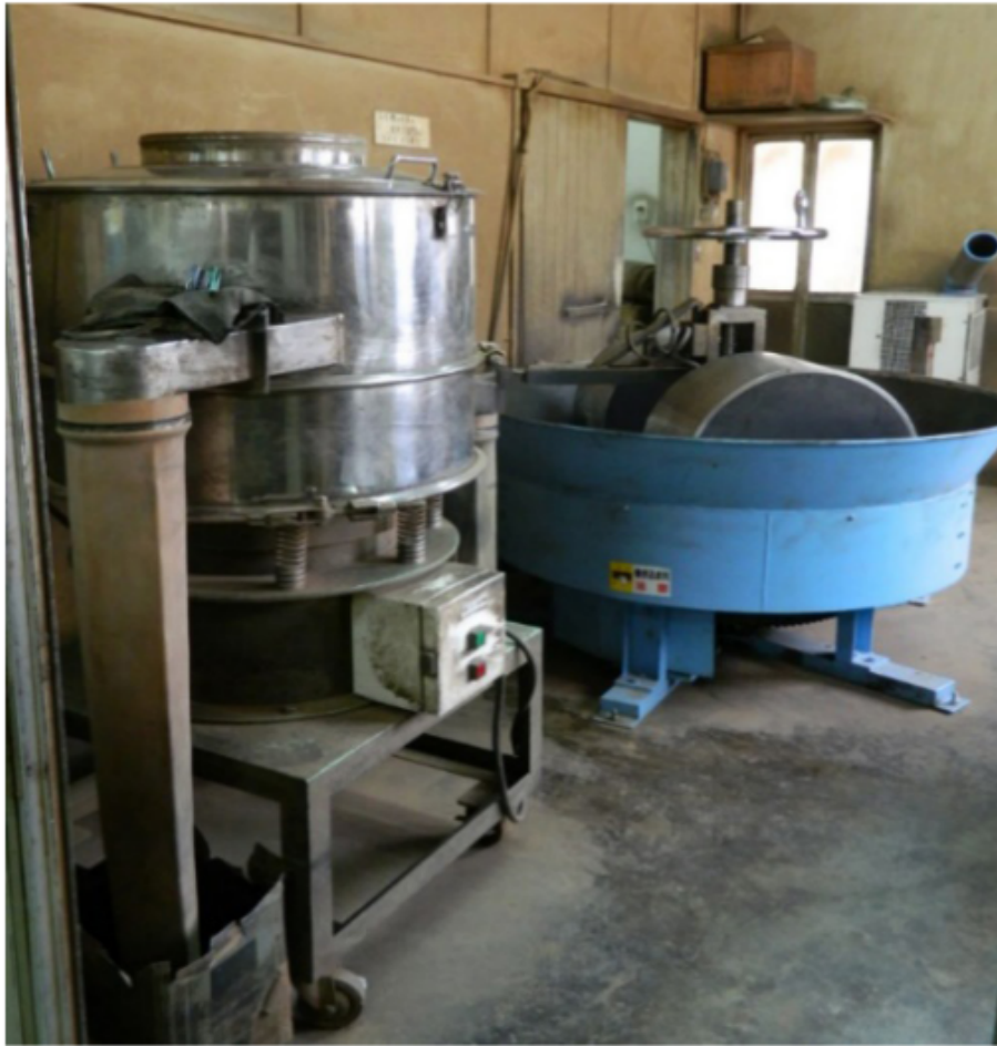
Gambar. 37. Mesin pembuat adonan dupa yang berfungsi sebagai pengaduk dan penggilas.
