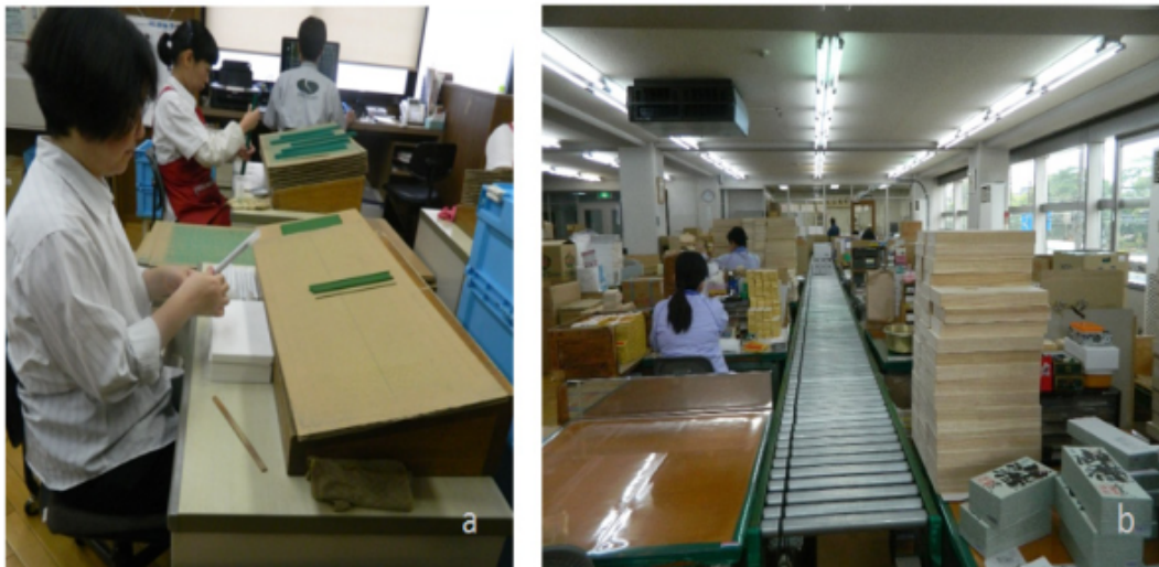
Gambar. 45. Proses pengemasan dupa. Catatan: a. Pengepakan dupa; b. sabuk berjalan untuk mengangkut dupa yang telah dikemas.
