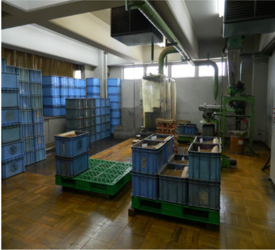
Gambar. 36. Hasil dari pencampuran/ maxing bubuk dupa., dari mesin melalui proses ayakan untuk menghilangkan kotoran.
