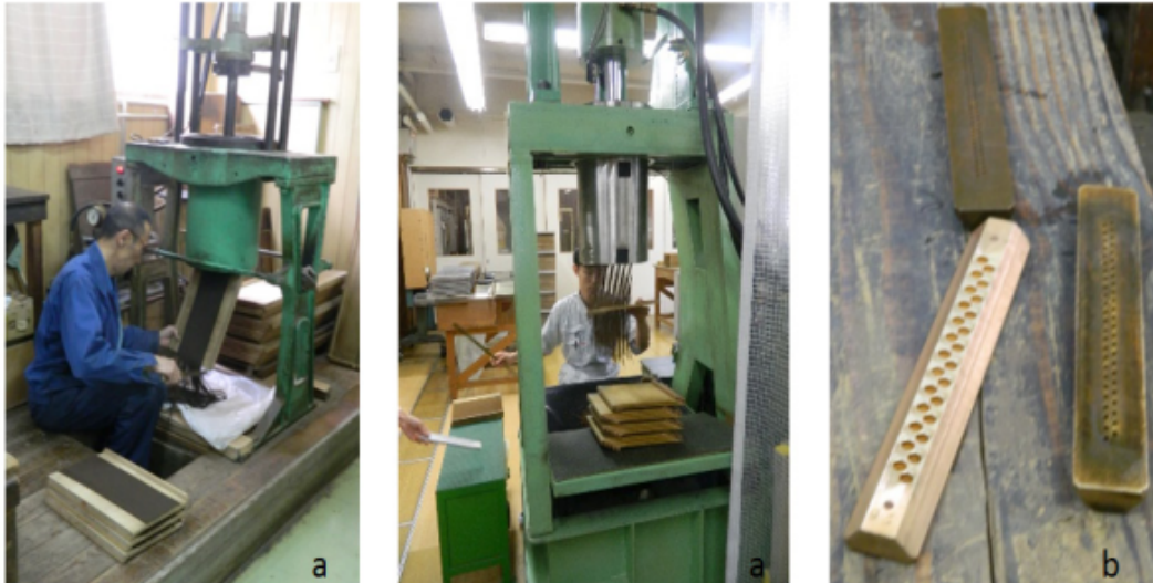
Gambar. 38. Mesin pencetak dupa atau sebuah mesin ekstruder hidraulik, Keterangan: a. Mesin untuk mencetak bentuk stik. b. bentuk cetakan dupa.
