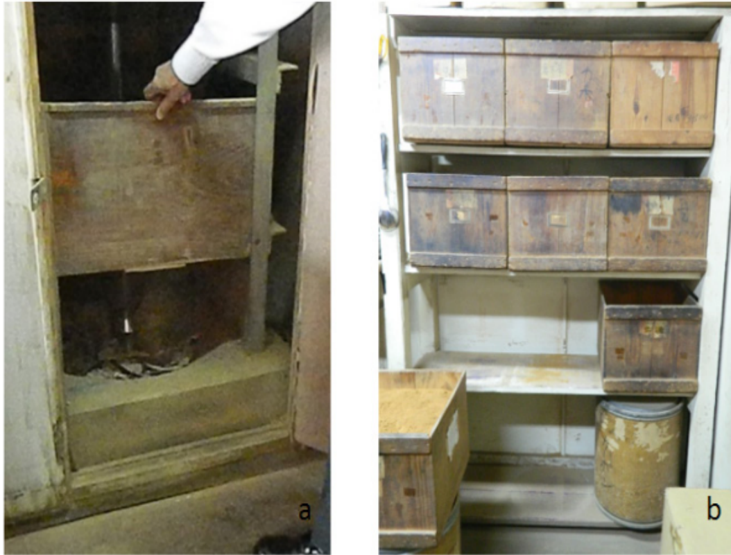
Gambar. 34. Mesin penumbuk bahan dupa. Keterangan: A. Mesin Penumbuk, B. Bok kayu tempat Material Bubuk/powder.
