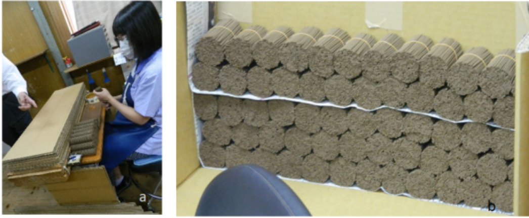
Gambar. 44. Pengikatan dupa. Catatan: a. Stik diikat bersama dengan berat tetap untuk mencegah lekukan apa pun; b. dupa terikat.
