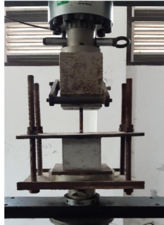
Gambar 5. Uji Tegangan Lekat dengan Pull Out
