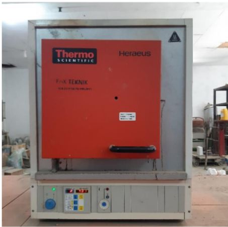
Gambar 4. Proses Pembakaran Benda Uji dengan Furnace
