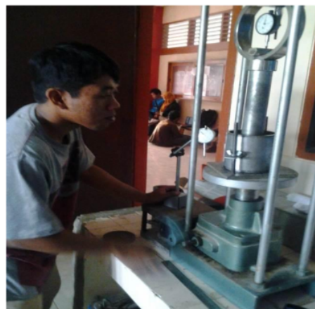
Gambar 4. Foto Pelaksanaan Pengujian CBR di Laboratorium
