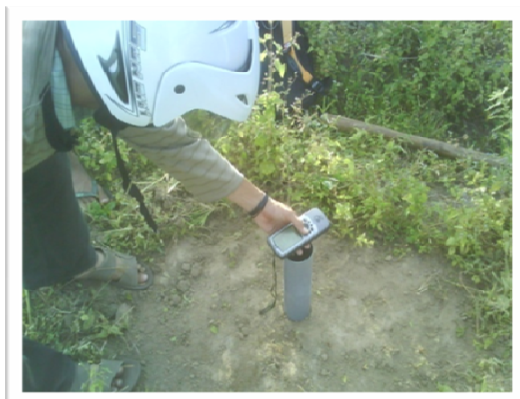
Gambar 3. Pencatatan koordinat lokasi pengambilan sampel dengan alat GPS
