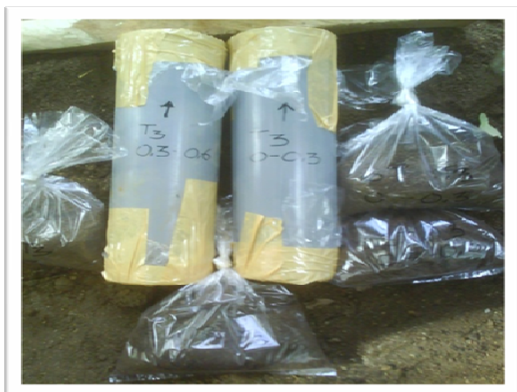
Gambar 2. Sampel tanah asli (undisturb) dan sampel tanah terganggu (disturb)
