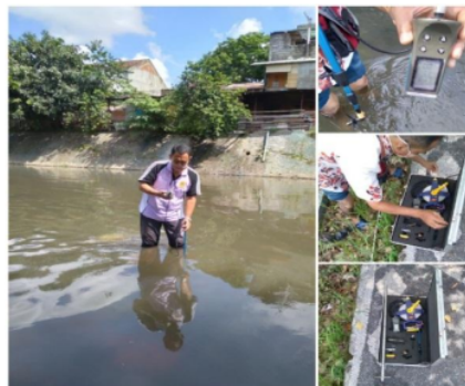
Gambar 2 Pengukuran kecepatan aliran Sungai Ancar dengan current meter digital .
