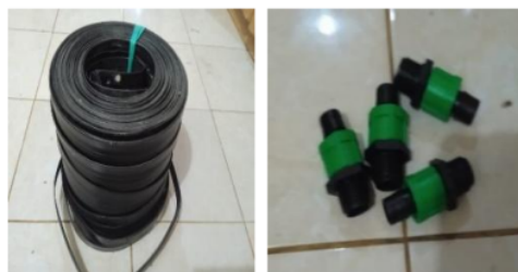
Gambar 2. Pipa tetes NTF dan Connector
