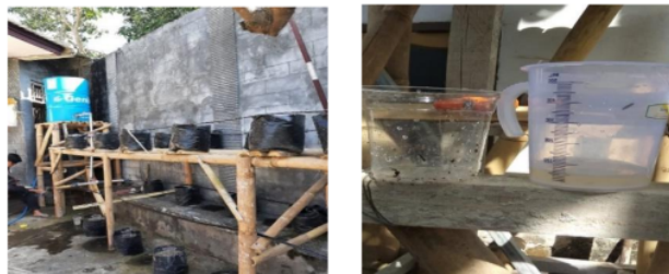
Gambar 2. Uji Jaringan irigasi tetes sistem bertingkat
