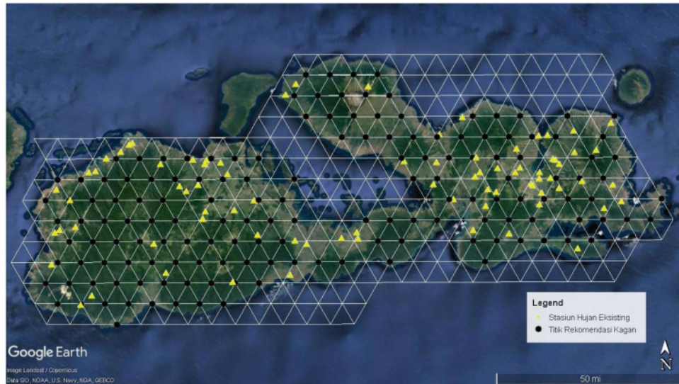
Gambar 5. Hasil plotting titik rekomendasi stasiun hujan dengan metode Kagan pada software Google Earth
