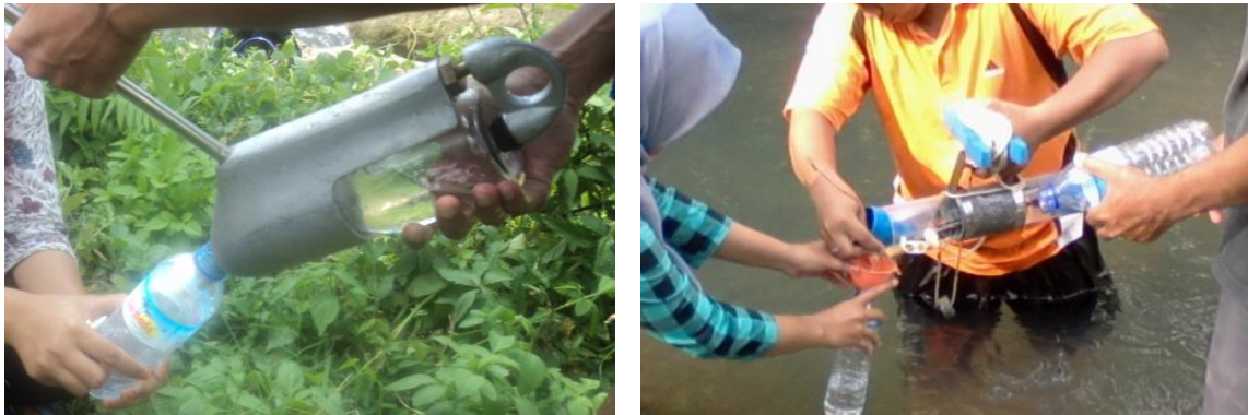
Gambar 15. Pemindahan sampel air dari USDH 48 dan water sampler model JT-1 ke wadah penyimpan
