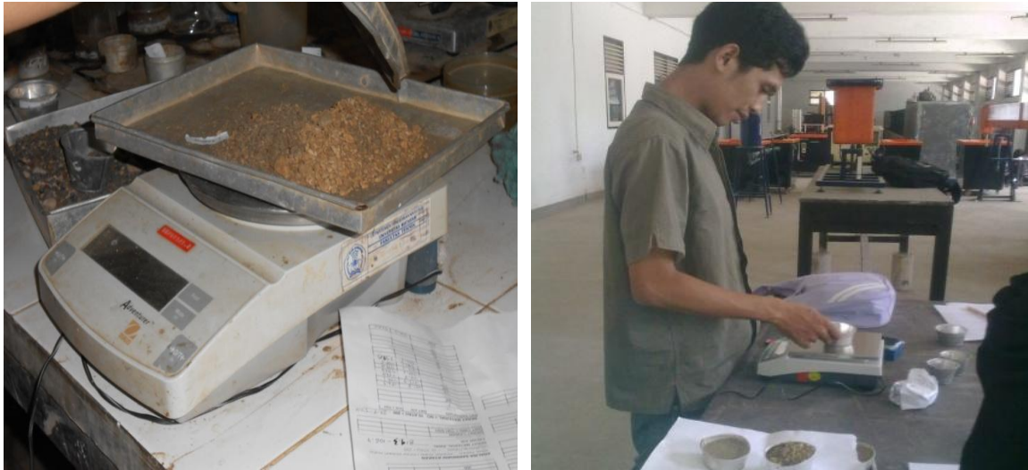
Gambar 19. Sampel sedimen ditimbang berat keringnya dan tetap diberi label
