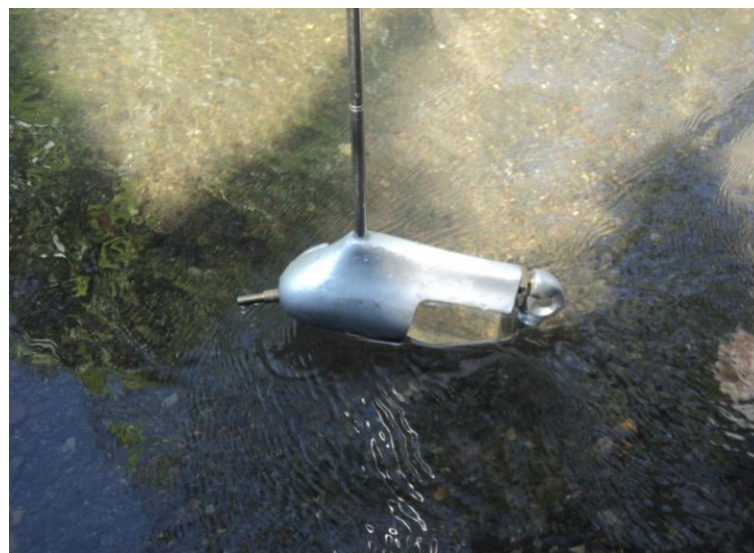
Gambar 14. Penggunaan alat ukur sampel sedimen tipe USDH 48
