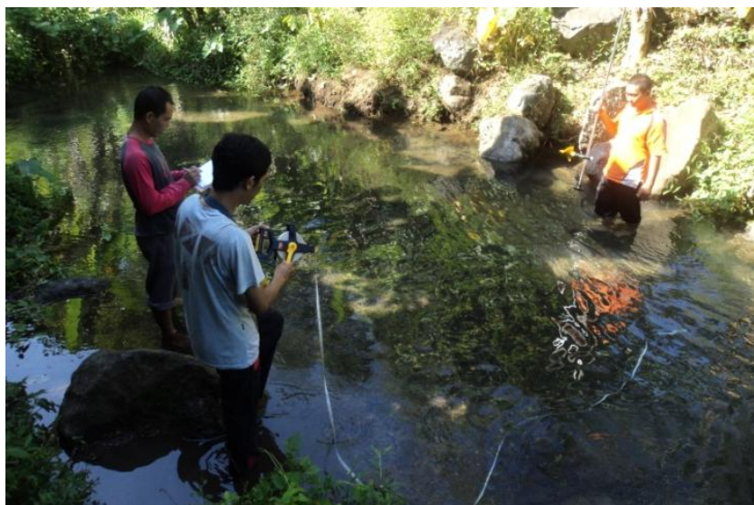
Gambar 10. Pengukuran luas tampang sungai
