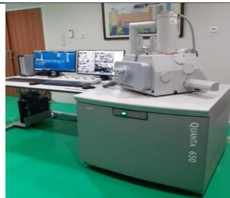
Alat SEM yang di gunakan di PT.Cipta Mikro Material jenis Quanta 650 thermofisher Amerika
