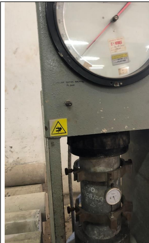
Proses uji tekan dan pembacaan data modulus elastisitas
