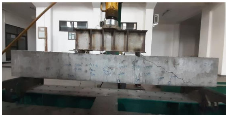
Gambar 4.4. Pola Retak (a) NC (b) CF
