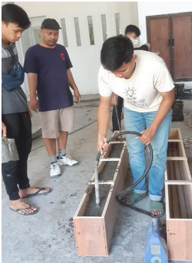
Gambar 3.13. Pembuatan benda uji balok
