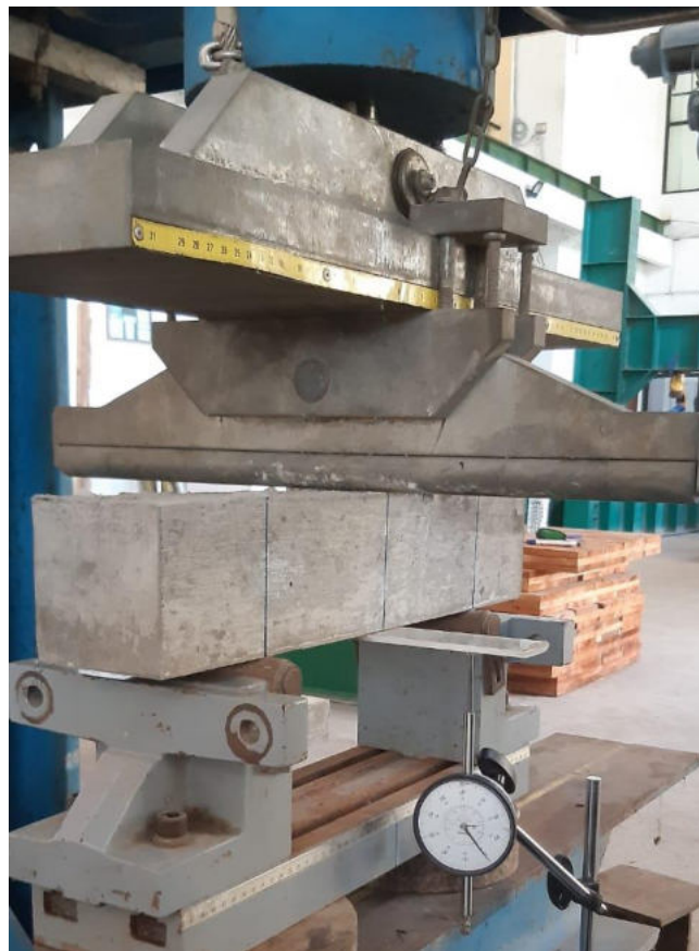
Gambar 3.18. Setting Uji Modulus Runtuh (MoR)
