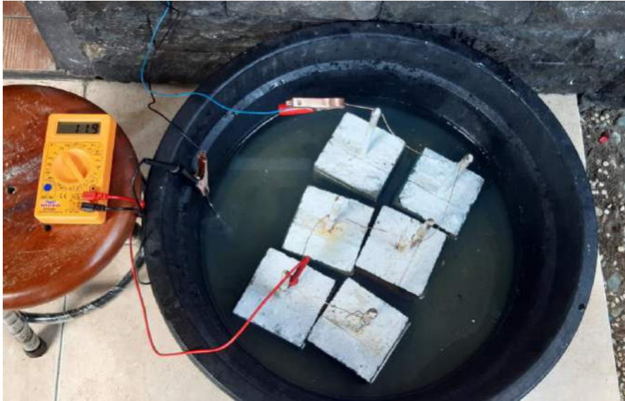
Gambar 3.7. Proses pemberian korosi awal ( initial corrosion )
