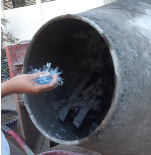
Gambar 3.8. Penambahan plastik PET ke dalam campuran beton
