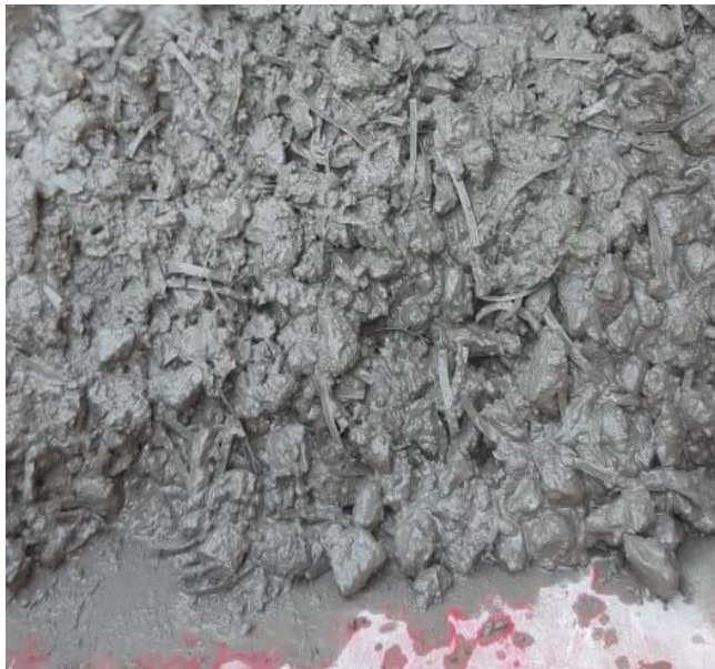
Gambar 3.9. Hasil pencampuran beton dengan penambahan plastik PET
