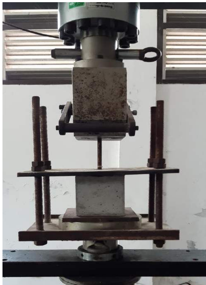
Gambar 3.4. Uji tegangan lekat dengan Pull out
