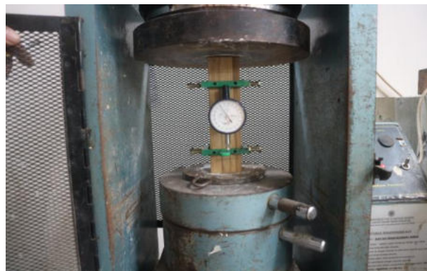
Gambar 3.6. Setup Pengujian Kuat Tekan
