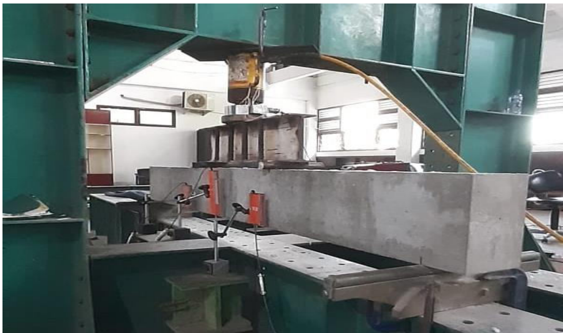
Gambar 3.19. Setting Uji Kapasitas Lentur
