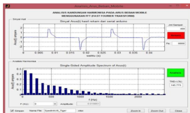
Gambar 9 Hasil identifikasi dan pengolahan kandungan harmonisa arus pada charger sepeda listrik.
