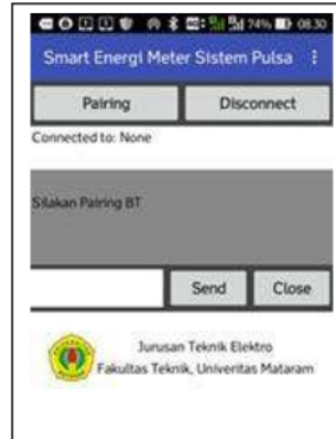
Gambar 6. Tampilan program koneksi BT ke meter pada smartphone
