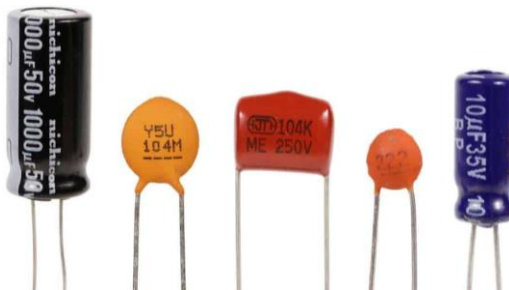
Gambar 2.4 a. Bentuk fisik dari beberapa tipe kapasitor
