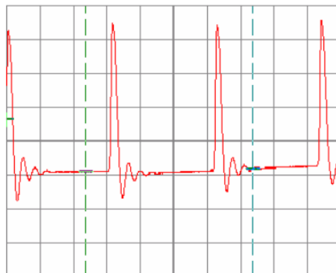
Gambar 11. Lampu TL merek Focus 1 pada catu 160 V, frekuensi switching 800 Hz, tanpa kapasitor dan Trafo Ballast. Tegangan 100 V/Div, TB 1 ms/Div
