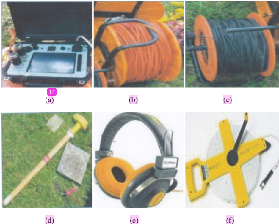
Gambar 2: (a) seismograph , (b) kabel geophone , (c) Kabel Trigger , (d) Palu dan Plat Besi (e) earphone , (f) meteran
