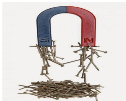
Gambar 2 : Magnet Menarik Benda-Benda dari Unsur Besi
