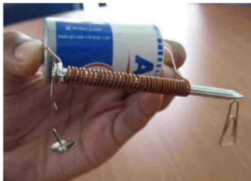
Gambar 4 : Magnet dapat Dibuat dari Arus Listrik
