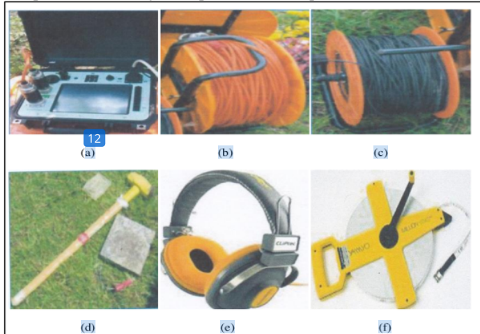
Gambar 2. (a) seismograph, (b) kabel geophone, (c) Kabel Trigger, (d) Palu dan Plat Besi (e) earphone, (f) meteran
