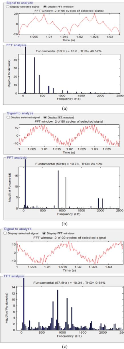
Gambar 10. Arus faase stator maksimum menggunakan (a) Metode konduksi 180°, (b) Metode SPWM, (c) Metode SVWM
