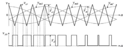
Gambar 3 Prinsip pembangkitan sinyal dengan SPWM. [10]
