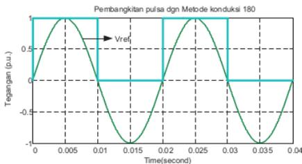
Gambar 2. Prinsip pembangkitan sinyal dengan metode konduksi 180°.
