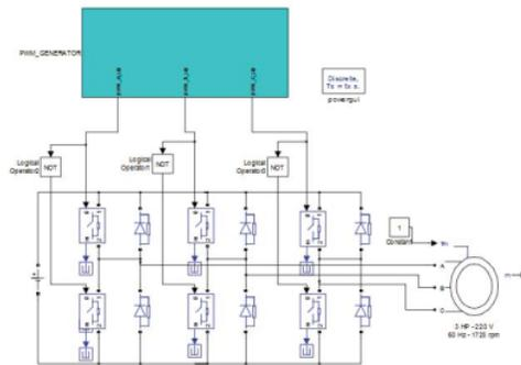
Gambar 7 Blok simulasi sistem pengaturan kecepatan motor induksi tiga fase.
