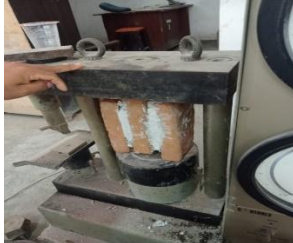
Gambar 2. 1. Pengujian Kuat Rekat Mortar.
