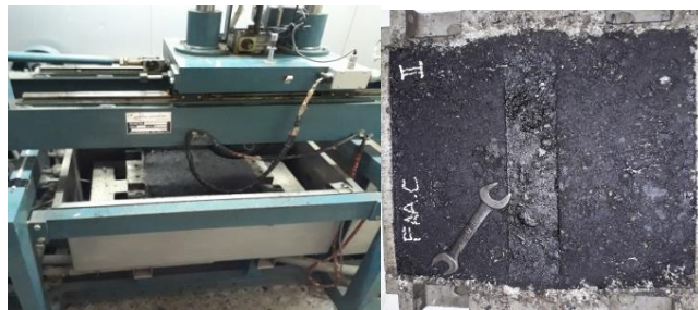
Pengujian dengan WTM
