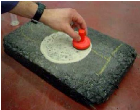
Gambar 3.16 Pengukuran Tekstur dengan Sand Patch Method
