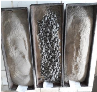
Menyiapkan agregat dan aspal sesuai komposisi
