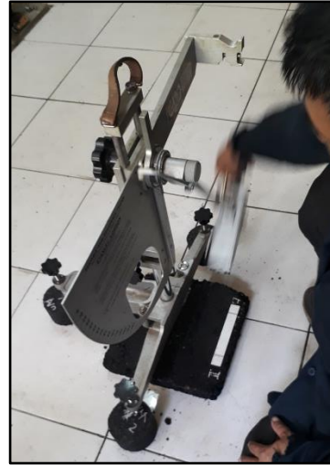
Pengujian BP Pasca Tracking
