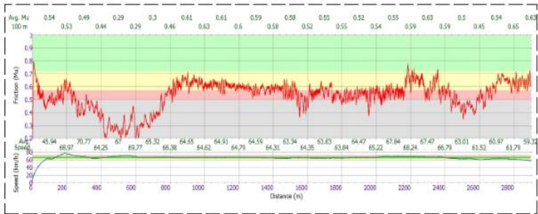
Gambar 4.57. Hasil Pengukuran Skid Resistance dengan MU Meter 3 m Sebelah Kiri Center line dari R10–R28 Bandara Internasional Juanda (PT Angkasa Pura I, 2016)
