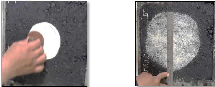
Gambar 4.44. Pengukuran Tekstur dengan Metode Sand Patch Pre Tracking (lingkaran di tengah sampel)
