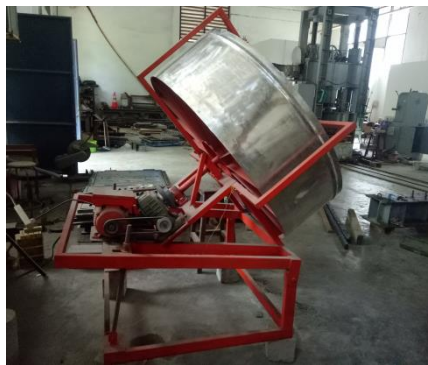
Gambar 4.4 Granulator untuk Pembuatan Agregat (Laboratorium Struktur, Departemen Teknik Sipil, FTSLK, ITS)
