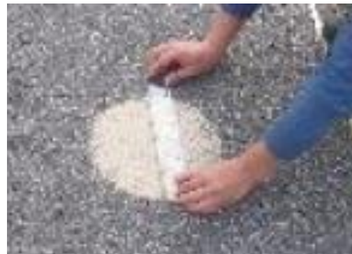
Gambar 3.16 Pengukuran Tekstur dengan Sand Patch Method
