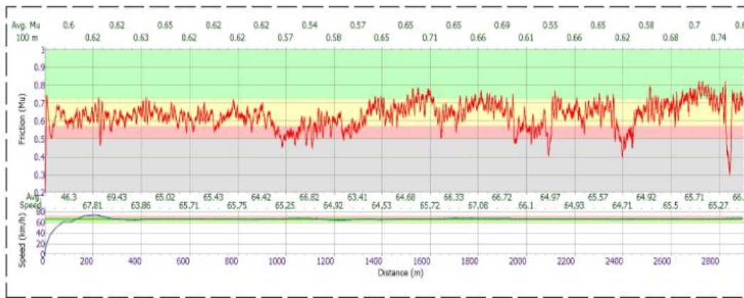
Gambar 4.56. Hasil Pengukuran Skid Resistance dengan MU Meter 6 m Sebelah Kiri Center line dari R10–R28 Bandara Internasional Juanda (PT Angkasa Pura I, 2016)
