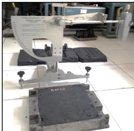
Gambar 4.45. Persiapan Alat dan Sampel Uji British Pendulum Tester
