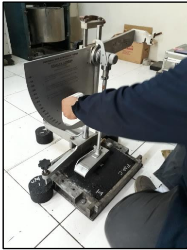
Pengujian BP Pra Tracking
