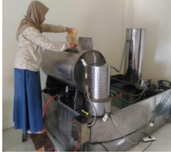
Gambar 7. Penggorengan keripik dengan Penggoreng vakum ( vacuum frying )
