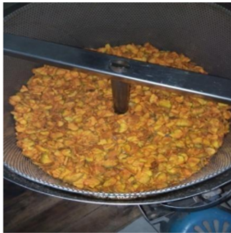
Gambar 8. Penghilangan sisa minyak pada keripik dengan alat spinner
