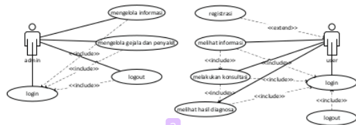
Gambar 3. Diagram use case sistem pakar diagnosa penyakit gigi menggunakan Bayesian Network Berbasis Website
