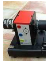
Gambar 10. Tachogenerator Sebagai Sensor Kecepatan (Ardiansyah, 2014)
