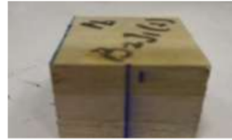
Gambar 2. Hasil pengujian perubahan dimensi papan laminasi
