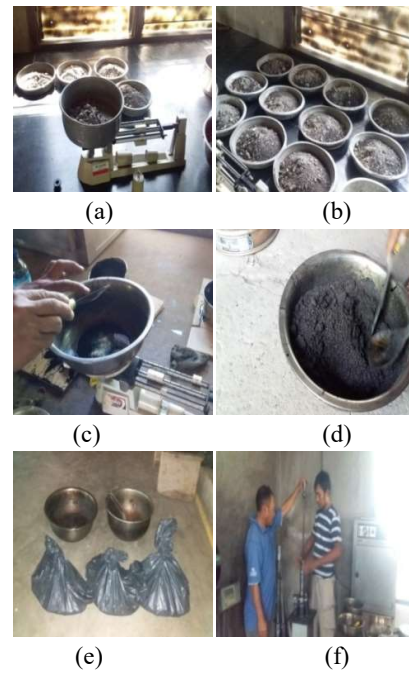
Gambar 5. Proses Pembuatan Benda uji; (a) Penimbangan material campuran; (b) Material sesuai proporsi; (c) Penimbangan aspal; (d) Campuran aspal; (e) Pemeraman campuran; (g) Pemadatan campuran
