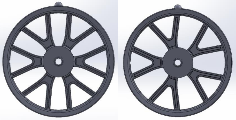
Gambar 1. Desain rim palang 12 (kiri) dan rim palang 10 (kanan)
