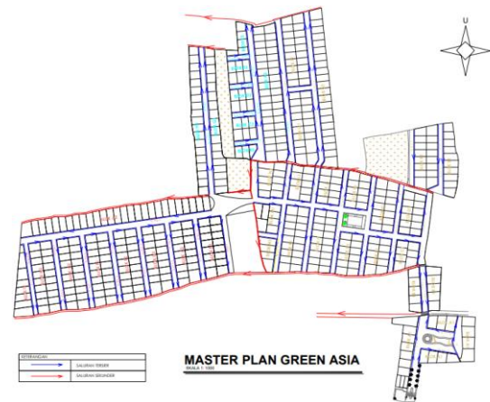
Gambar 4.2 Skema saluran drainase
